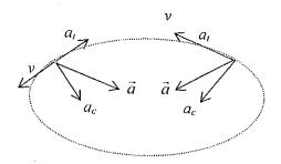
Por eso, el módulo de  $\vec{v}$  va cambiando: de a ratos aumenta, de a ratos disminuye. La componente radial (ojo, el eje radial no va hacia el centro de la elipse sino que es perpendicular al tangencial) existe en todo punto, ya que es la responsable del cambio de dirección de  $\vec{v}$ .
